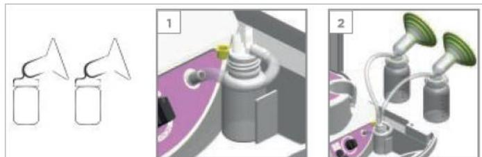
**AVERTISSEMENT :** Fermez correctement le bouchon du flacon d'interface lorsque le tire-lait est utilisé en simple pompage.
